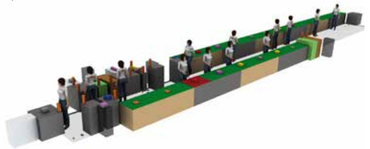
3D-Modell einer Continuous Flow Montagelinie für Autositze
