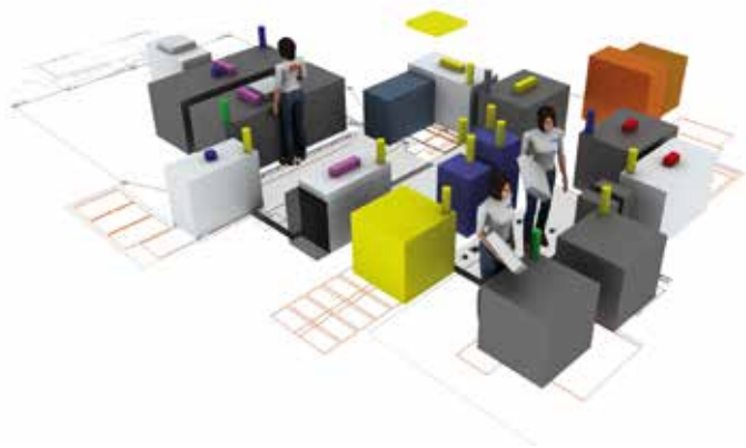
3D-Simulationsmodell einer Autositz-Montagezelle zur Materialflussoptimierung
