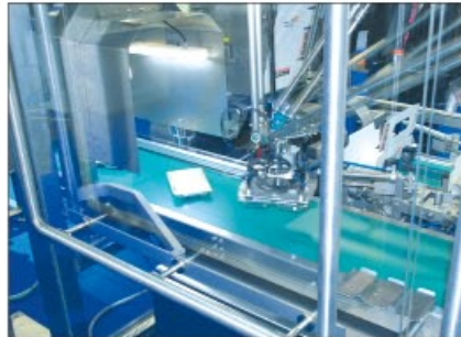
Der PacDrive P4-Roboter nimmt die ankommenden Verpackungen auf und richtet sie aus, im Hintergrund stehen die Kartons für den anschließenden Einsatzvorgang bereit
